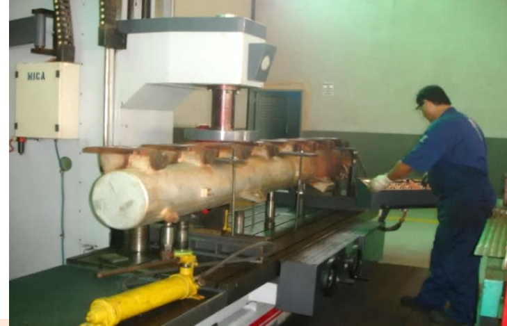
Rectificación de superficies planas y Reparación interna de Manifold, Múltiples de Agua, Cámaras, Bloques, entre otros.
